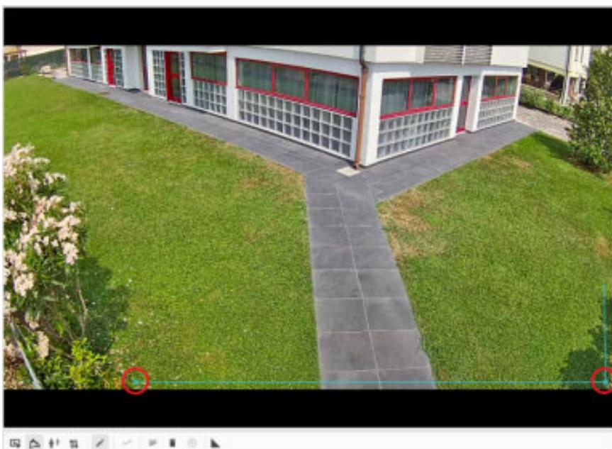
Si crea così un lato del poligono, congiungendo i primi due vertici. Si prosegue il disegno cliccando sul terzo vertice e sui successivi, fino a che, cliccando nuovamente sul primo vertice, si chiude il poligono, definendo l'area di interesse.
